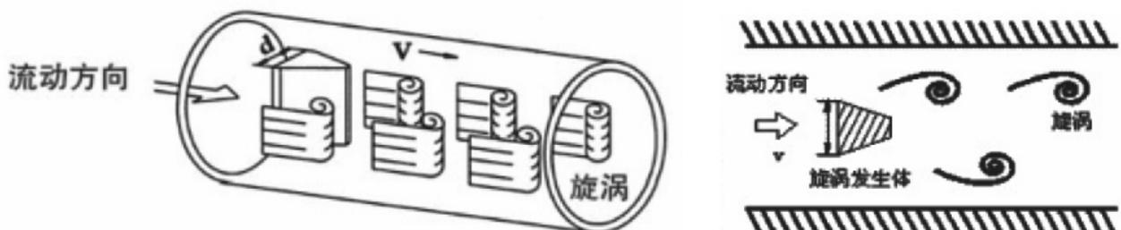
这些交替变化的旋涡就形成了一系列交替变化的流体升力，该升力作用在基于压电效应的检测探头上，便产生一系列交变电荷信号，经过前置放大器转换、整形、放大处理后，输出与旋涡脱落频率相同且与流速成正比的脉冲信号。
